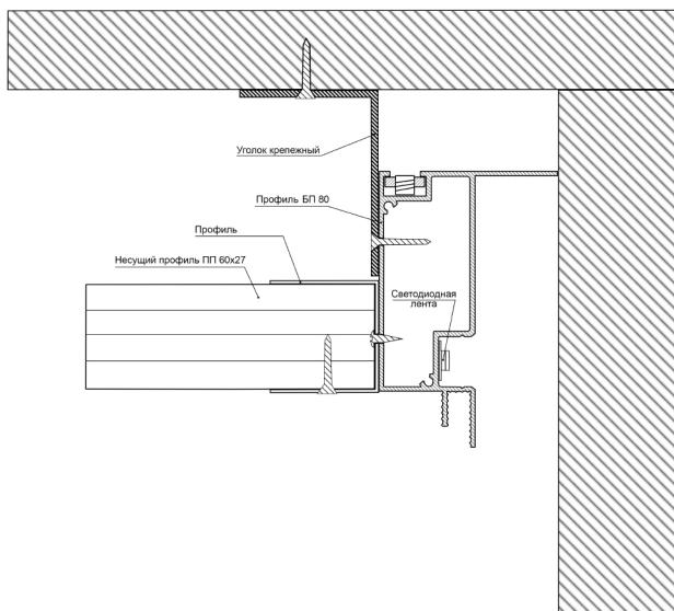
Установите несущий каркас к основному потолку и профилю БП 80 с учётом количества слоёв и толщины гипсокартона. Если нужно, установите и подключите светодиодную ленту.
