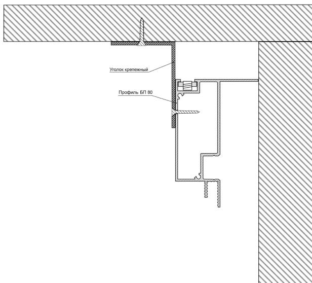
Соберите нужную конфигурацию профиля БП 80 с помощью соединителей и винтов, затем установите профиль на уголках на нужном расстоянии от стены.
