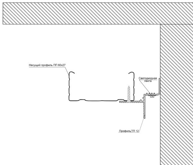
Сделайте зенковку отверстий в профиле ТП 12 в местах крепления и прикрутите его к несущему каркасу. Если нужно, установите и подключите светодиодную ленту.
