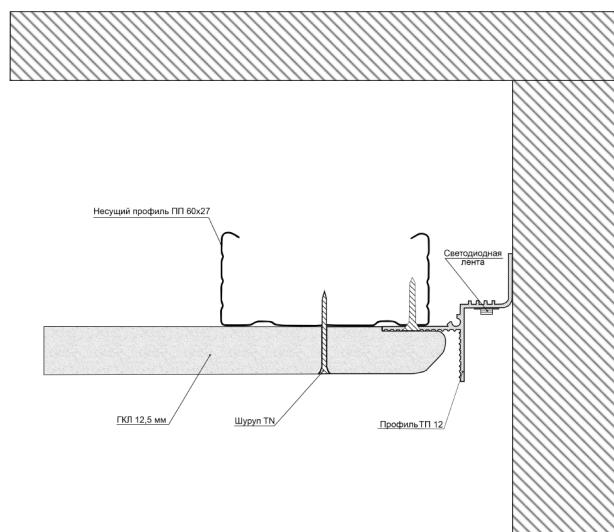
Сделайте фрезеровку листа гипсокартона в месте прилегания к профилю ТП 12. Затем установите гипсокартон к несущему каркасу с отступом от края лицевой стороны профиля ТП 12 в 5 мм или снимите фрезу с гипсокартона под 45 градусов на углу.
