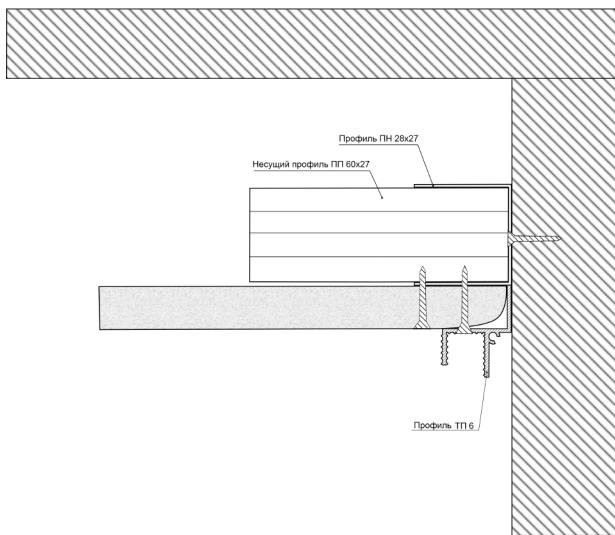
Установите профиль ТП 6 вплотную к стене, прикрутив его к каркасу через слой гипсокартона.
