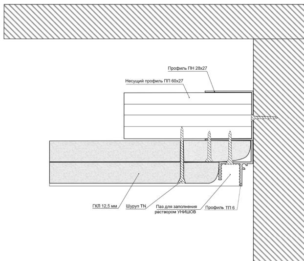
Установите нижний слой гипсокартона к несущему каркасу. Затем выполните отделочные работы (стеклохолст, шпаклёвка, покраска).
