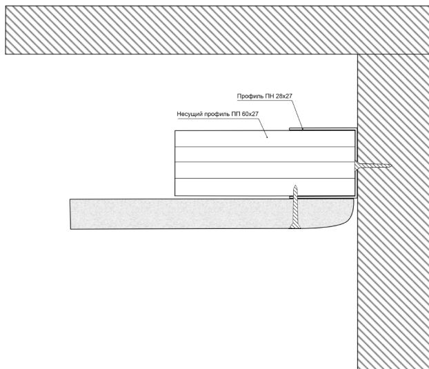
Установите верхний слой гипсокартона с отступом от стены от 2 до 5 мм.
